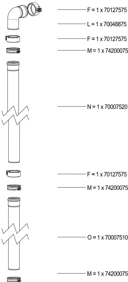
Rohrsystem 4,0 m / pipe system 4,0 m / système de tuyau 4,0 m /
