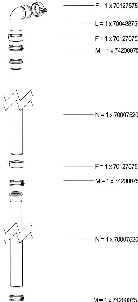
SitaAttika Kaskade für Fallleitung / for downspout / de descente / afvoerset /
